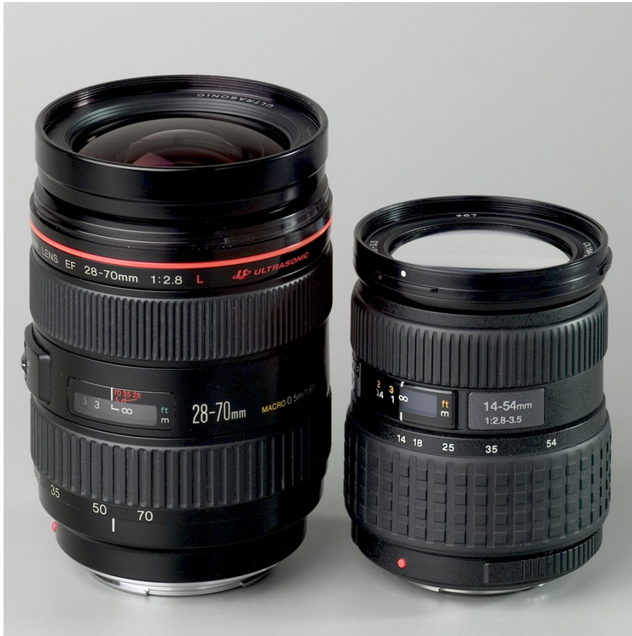
Canon 28-70mm f/2,8 L vs. Zuiko 14-54mm (equiv. 28-108mm) f/2,8-3,5 ( Valentín Sama© )
